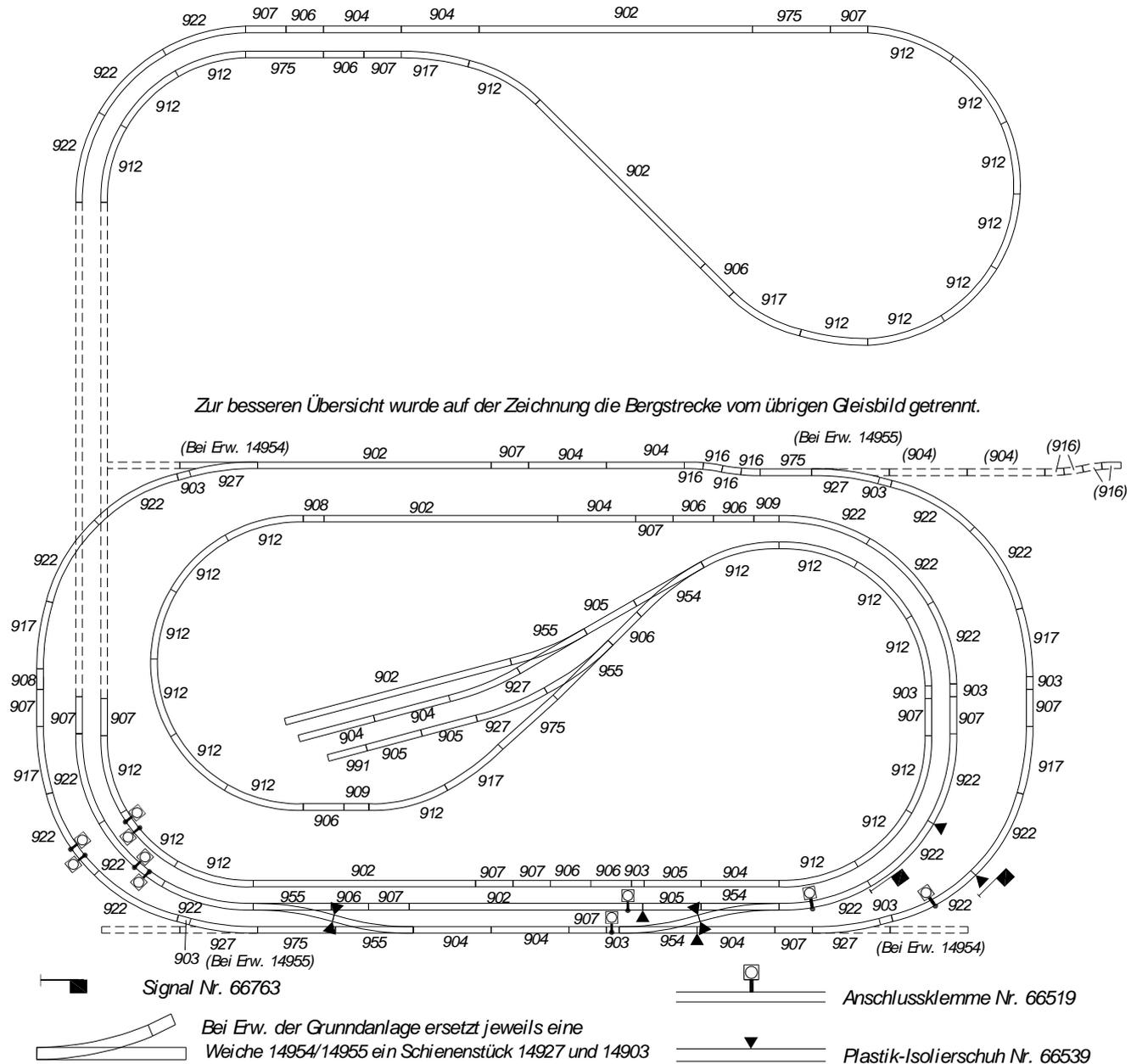
Die Weichen des Überholgleises/Abstellgleises können durch Entfernen der äußeren Drahtbrücken in zweiseitig wirkende Stop-Weichen verwandelt werden.
